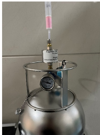
图 28 恒定流量控制器加装除 CO 2 小柱连接采样罐示意图
